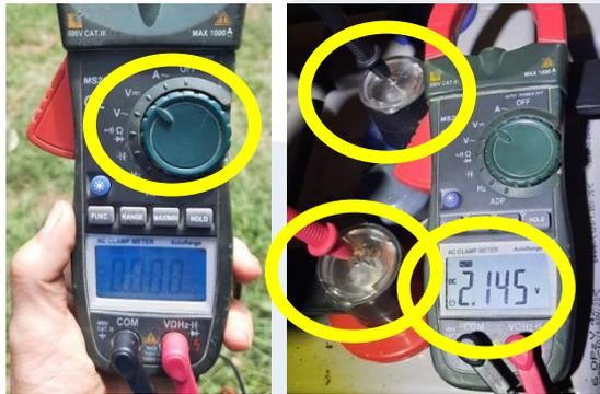
Voltmètre sur VDC – Mesure du bloc de 2V à 2.145 Volt ✓
